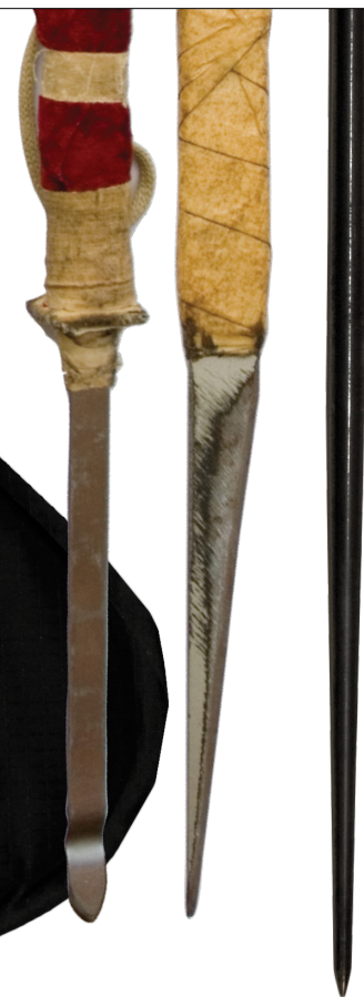
The actual NIJ spike used in the NIJ Standard 0115.00
